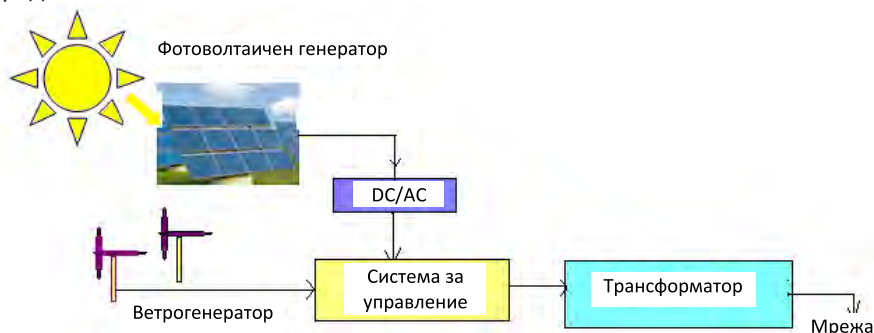
Фигура 2.29: Пример за хибридна система за производство на енерги
