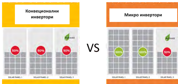
Фигура 2.24: Влияние на засенчването при системи с конвенционални и микро инвертори
